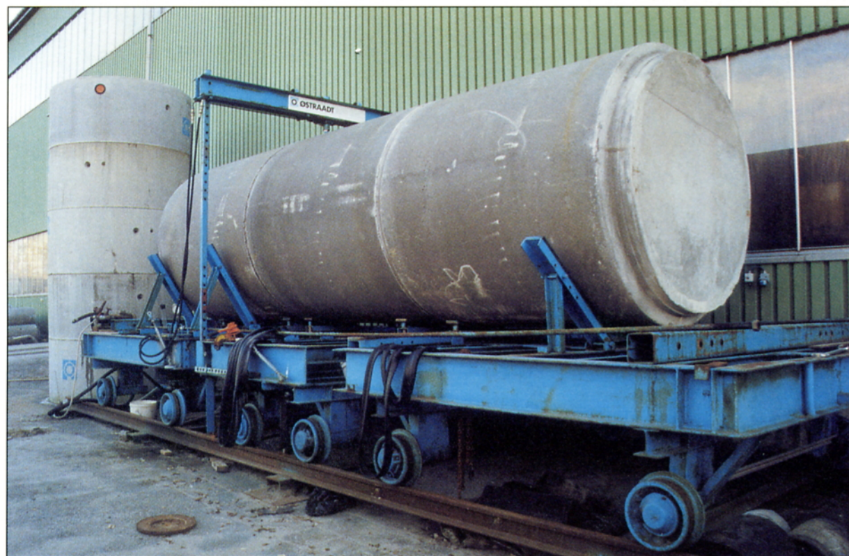
Her eksempel på funksjonstest i vår prøvebenk på Sviland, hvor vi tester tetthet i h.h.t. krav i BN1030. For øvrig en prøvebenk som benyttes av flere produsenter i tilsvarende tester.
