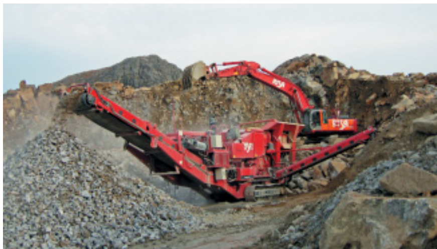
Steinknuser og gravemaskin som "mater" stein.
