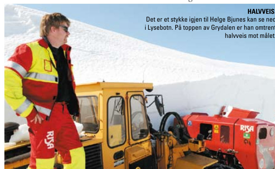
KASTER SNØ: Med en kraft på 430 hestekrefter kaster snøfresen til Risa AS snøen 15 meter til værs og langt ut til sidene.
