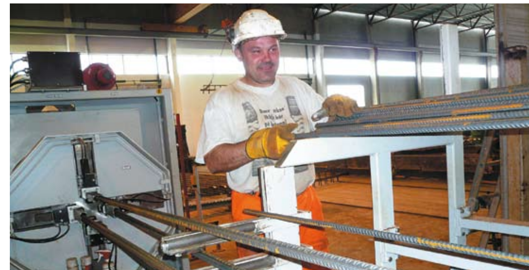
Roboten mates med armeringsjern.
