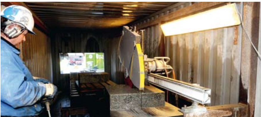
PÅ MÅL: De 18 centimeter tykke steinhellene blir skjært på mål angitt i tegningene til prosjektet.
