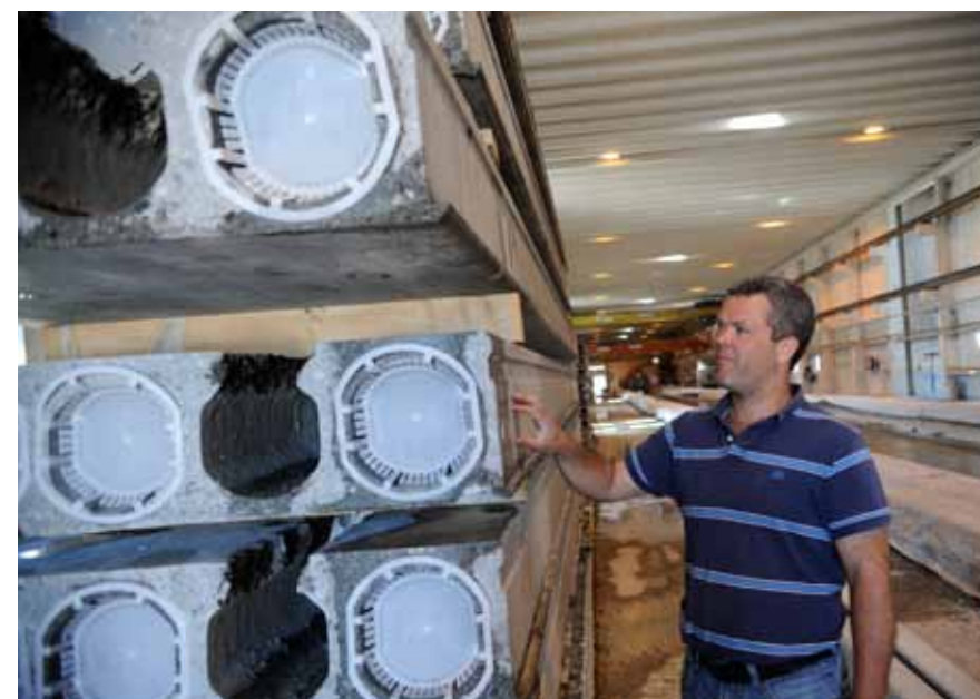
I FULL GANG: Fabrikksjef Tommy Svensson konstaterer at hulldekkproduksjonen går for full ved fabrikken i Mandal.
